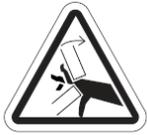
**Ne mettez jamais** vos mains, doigts, ou jambes sur des pièces en mouvement ou sous un capot de protection. Certaines pièces sont en mouvement et certaines pièces sont chaudes sous ces capots.
