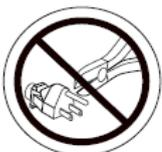
La suppression de la fiche de mise à la terre peut créer un danger électrique. S'il faut utiliser une fiche à 2 broches, installez un adaptateur approuvé. Ne jamais connecter de convertisseur AC/DC au chargeur des batteries.
