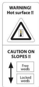
Votre **RZ500** est équipé d'un levier manuel de roues libres qui, lorsqu'il est positionné vers l'avant, permet de déplacer le **RZ500** manuellement.
