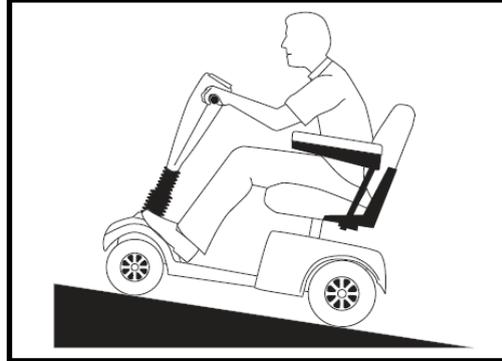
Figure C. Position de conduite à stabilité accrue
