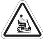
Le **RZ500** est capable de monter des pentes plus raides que celle recommandée comme étant sécuritaire. Ne jamais conduire sur des pentes dont vous ne connaissez pas l'angle d'inclinaison. Roulez toujours très lentement et ne jamais roulez de reculons sur de telles pentes.
