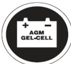
Utilisez seulement des batteries scellées à l'acide ou au gel qui ne nécessitent pas d'entretien.
