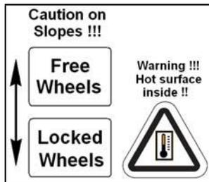
Ne desserrez jamais le levier de libération du frein électromagnétique (FEM) lorsque le **RZ500** est sur une pente. Lorsque le **RZ500** est sur une pente de quelque type que ce soit et vous êtes assis dessus ou debout à proximité ne jamais le mettre en mode "roues libres"
