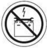
Gardez les outils et autres objets métalliques loin des pôles à batteries. Un contact avec un outil risque de causer un choc électrique. Personne n'est autorisé à être assis sur la **RZ500** lorsqu'il est positionné sur quelque type que ce soit d'ascenseur ou d'appareil de levage.
